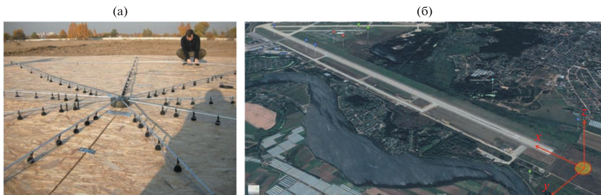
Рис. 3. (а) — Измерительная система из 108 микрофонов, развернутая на аэродроме; (б) — положение микрофонной антенны на аэродроме и используемая система координат.
