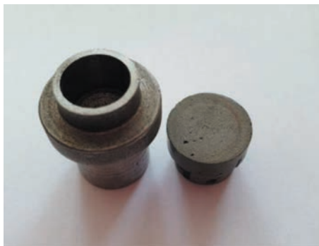
Рис. 7. Вид контрообразца из чугуна и образца из металлополимера после 2 \times 10^6 циклов испытаний.
