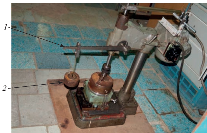
Рис. 1. Общий вид модельной установки: 1 – рычаг нагрузки; 2 – грузы.
