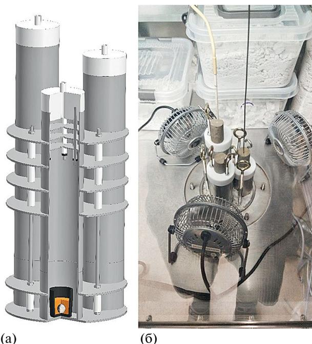
**Рис. 2.** Конструкция используемой в перчаточном боксе сборной установки для изучения высокотемпературной коррозии: *а)* внешний вид рабочей ячейки, *б)* конструкция рабочей ячейки
