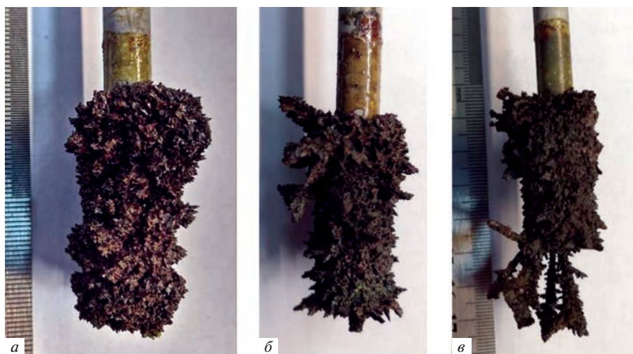
Рис. 6. Фотографии катодных осадков, полученных в ходе электрорафинирования U–Pd сплава с содержанием Pd в общей массе анода 1.58 мас. % при различных начальных катодных плотностях тока: а – 0.1; б – 0.2; в – 0.4 А/см 2 .
