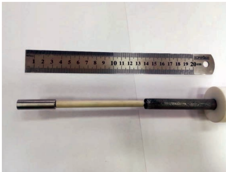
Рис. 4. Внешний вид катодной сборки (катод — слева).
