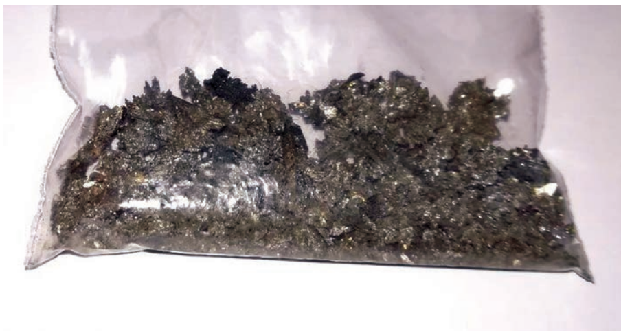
Рис. 5. Внешний вид отмытого катодного урана, направляемого в инертный бокс.
