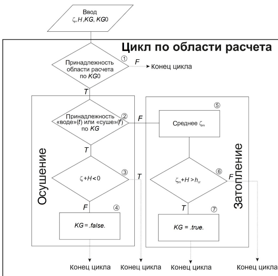
Р и с. 1. Блок-схема алгоритма расчета области затопления и осушения 4
