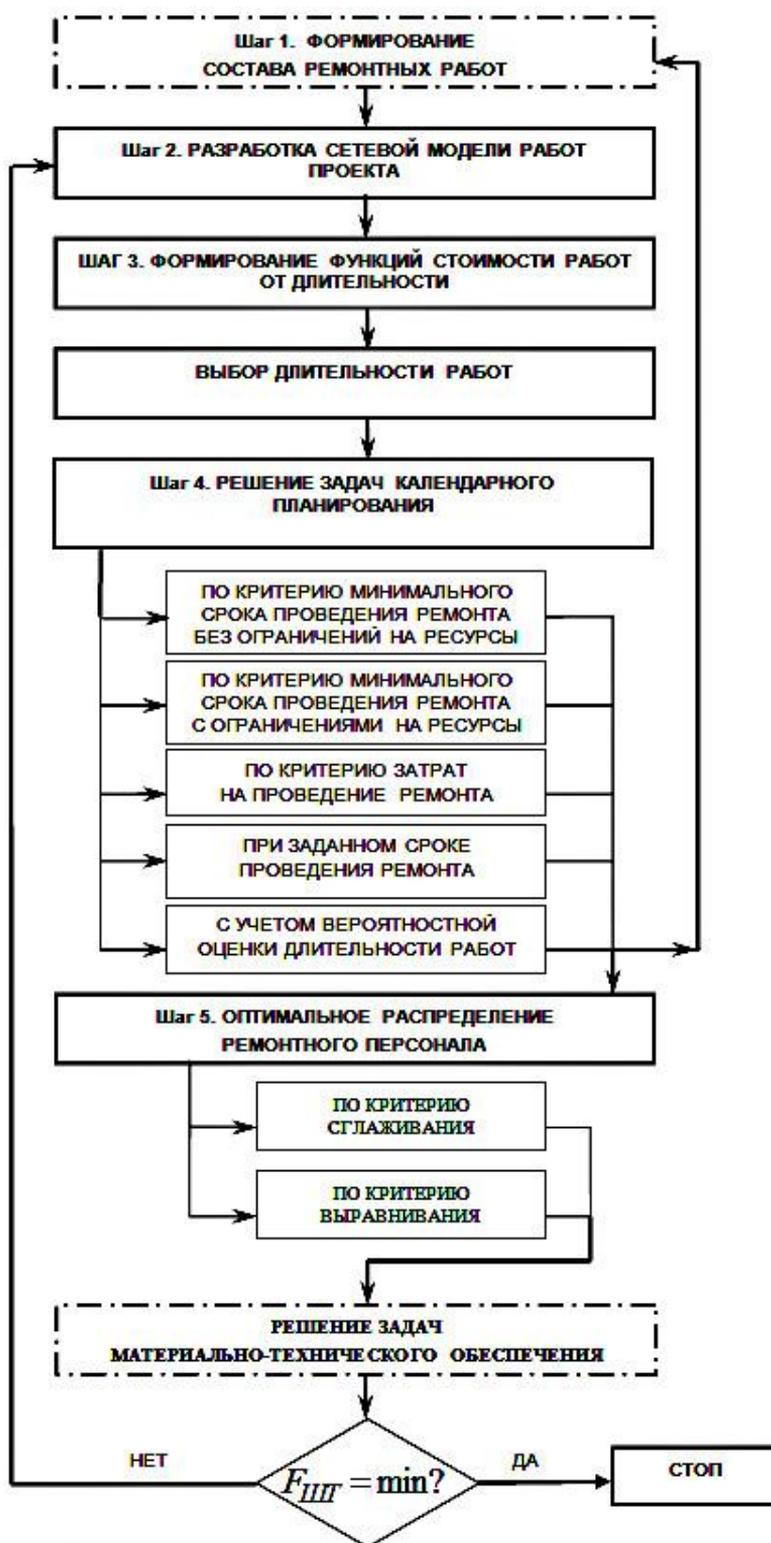
Рис. 3. Схема решения задачи планирования остановочных ремонтов
