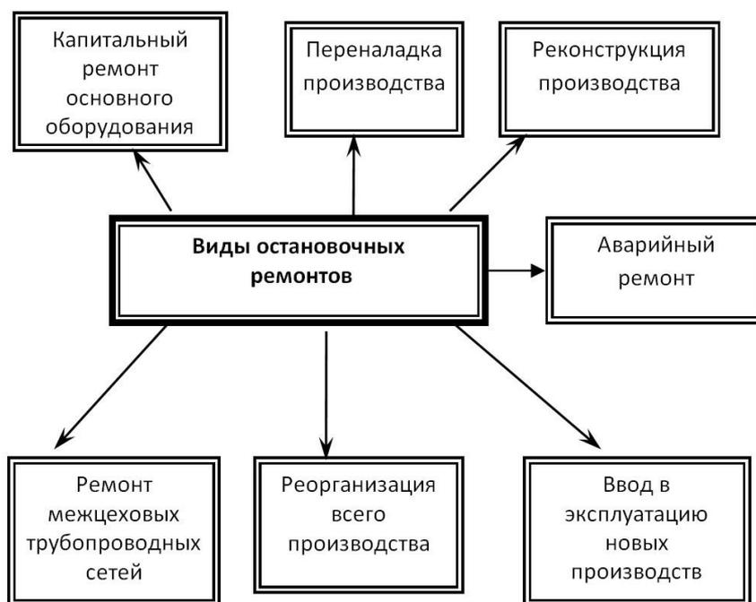
**Рис. 1. Ремонты, выполнение которых связано с частичной или полной остановкой производства**
