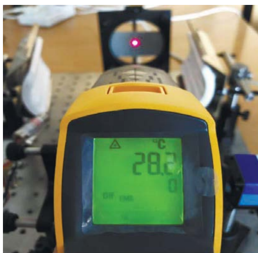
Рис. 5. Использование бесконтактного термометра для исследования температуры образца в любой момент времени.
