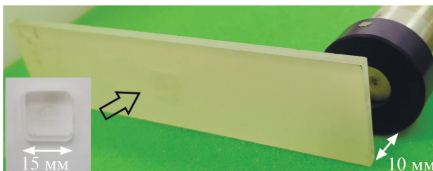
Рис. 9. Расположение ГЭАП и исследуемого образца с модельным дефектом в ходе эксперимента.
