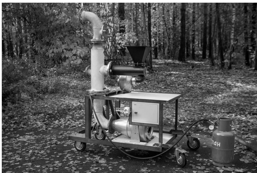
Рис. 2. Установка генерации горящих и тлеющих частиц [19].
