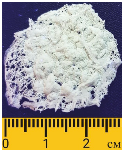
Рис. 1. Внешний вид экспериментального образца, сформированного из порошка PMMA без частиц полупроводника.
