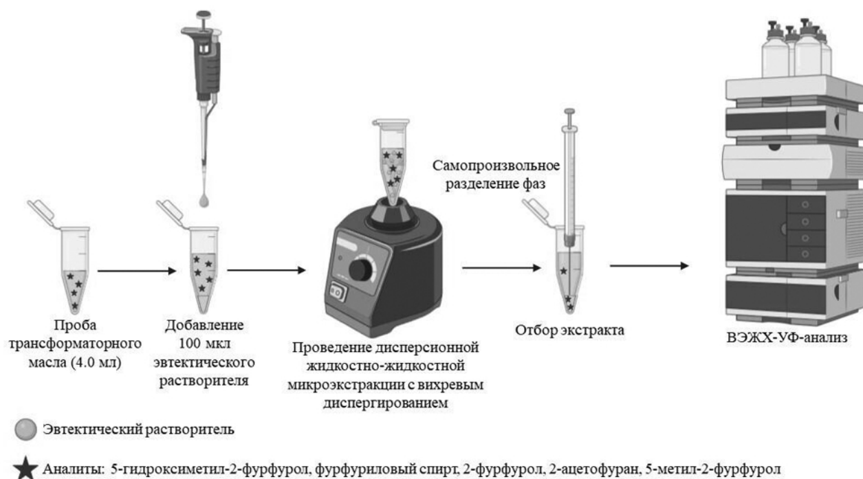
Рис. 4. Схема выполнения микроэкстракционно-хроматографического определения фурановых производных в трансформаторном масле.
