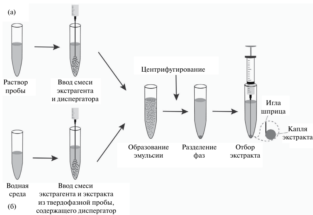
Рис. 4. Схема дисперсионной жидкостно-жидкостной микроэкстракции при концентрировании микотоксинов из водного раствора пробы (а) или экстракта из твердофазной пробы (б).
