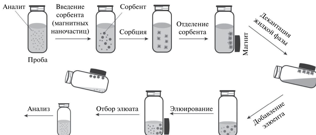
Рис. 6. Схема дисперсионной твердофазной микроэкстракции с применением магнитных наночастиц.
