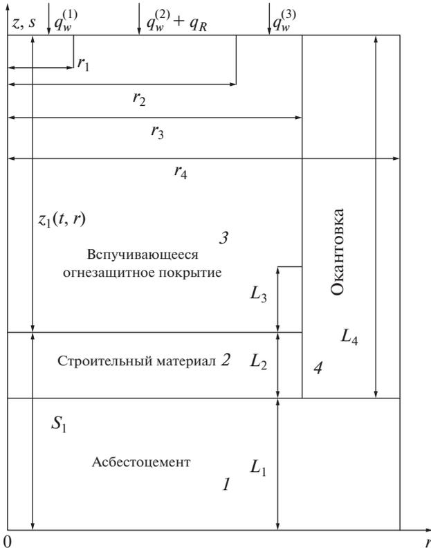
Рис. 1. Схема теплообмена тела с внешней средой.
