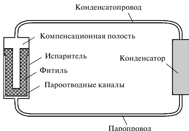
Рис. 1. Принципиальная схема КТТ.
