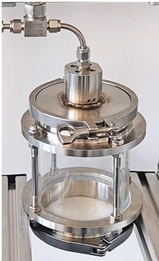
**Рис. 2.** Внешний вид камеры расширения.
