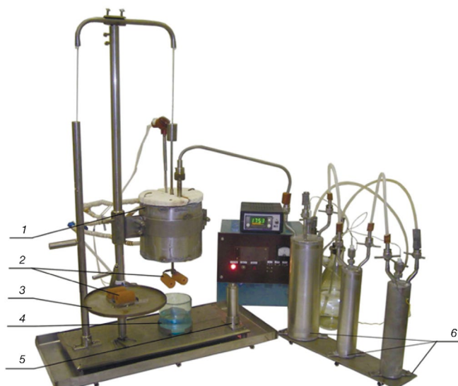
Рис. 3. Установка «ПОРА» для отработки процесса с раствором модельного реэкстракта цезия. 1 – электрическая печь; 2 – два блока ПНМ; 3 – поворотное дно печи с двумя блоками ПНМ; 4 – емкость с реэкстрактом Cs; 5 – пенал для двух блоков ПНМ, насыщенных \text{CsNO}_3 ; 6 – система газоочистки (набор из трех барботеров-конденсаторов).
