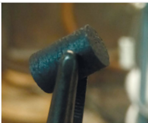
Рис. 7. Внешний вид спеченных таблеток. а — типичный вид таблеток из исходных порошков; б — таблетка из порошка, обработанного в ABC-150.
