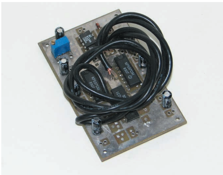
Рис. 3. Плата первичной обработки одноэлектронных сигналов ФЭУ, включающая в себя усилитель и временную привязку к постоянной части импульса. Размер платы 81 × 51 мм.
