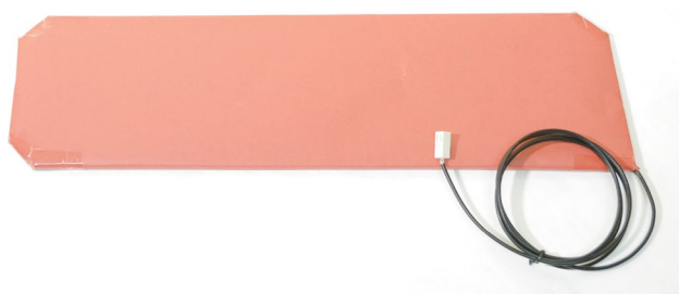
Рис. 9. Фото продольного тонкого счетчика вето-детектора в сборе.
