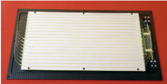
Рис. 10. Фото общего вида счетчика без светоотражающей и светозащитной обертки: сцинтилляционная пластина с WLS-волоконми, двумя SiPM, к которым присоединены торцы волокон, и электронным модулем.
