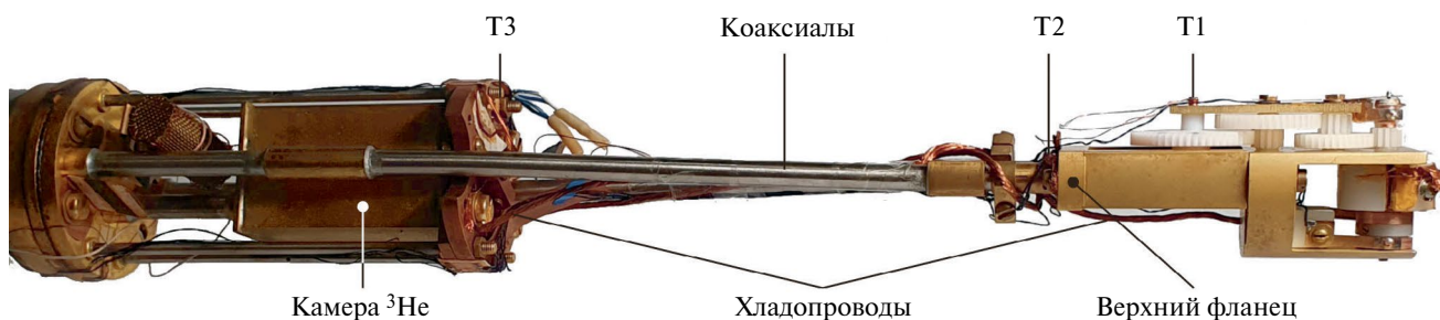
Рис. 2. Фотография устройства, смонтированного на СВЧ-спектрометре, совмещенный с криостатом откачки ^3\text{He} ; T1, T2 и T3 – термометры.
