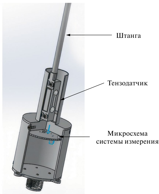
Рис. 11. 3D-модель угломера с указанием основных элементов.
