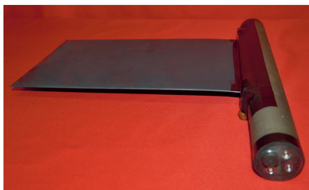
Рис. 2. Фото общего вида тонкого сцинтилляционного счетчика с размерами рабочей области сцинтиллятора 1 \times 200 \times 300 мм 3 .
