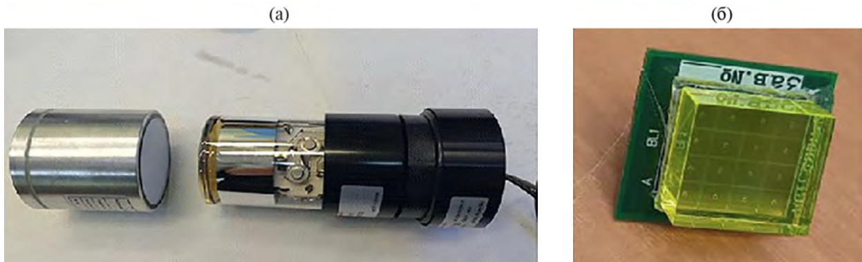
Рис. 2. Фото компонентов детектора рассеянных фотонов (а) и фото промежуточного рассеивателя из GAGG-сцинтиллятора и матрицы кремниевых фотоумножителей (б).
