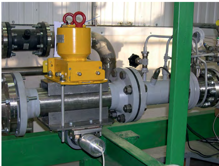
Рис. 9. Внешний вид макета двухизотопного \gamma -плотнмера DN 100 во время испытаний на стенде многофазных потоков ГЭТ195-2011, ВНИИР (г. Казань).
