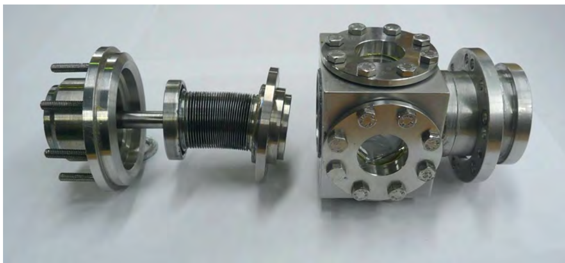
Рис. 4. Фотография камеры формирования монодисперсной струи. Вверху — обзорная фотография шлюза и камеры КФМС при снятом корпусе криостата, внизу слева — фотография шлюза, внизу справа — фотография камеры КФМС с установленными окнами.
