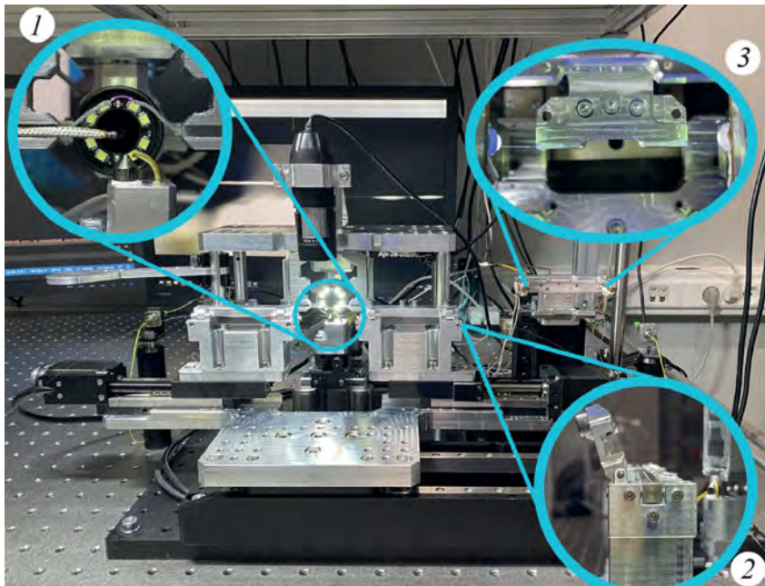
Рис. 2. Внешний вид экспериментальной установки: 1 – увеличенное изображение системы высокочастотного поджига и тушения пламени сжатым воздухом, контроль процесса горения осуществляется при помощи термопары; 2 – внешний вид системы фиксации волокна в направляющей с регулировкой по 4 степеням свободы; 3 – увеличенное изображение системы полимеризации клея на изготовленном волокне, закрепленном на вилке.
