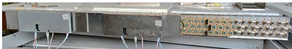
Рис. 7. Торцевая часть камеры с сигнальной стороны (сняты одна переходная плата и плата МТ-48).
