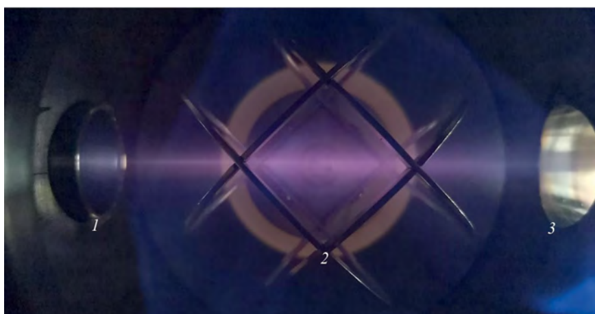
Рис. 9. Характерный вид свечения разряда в дейтерии в камере ИЭУП при работе ПИИ: 1 – ПИИ, 2 – сетчатый катод, 3 – смотровое окно.
