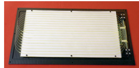
Рис. 10. Фото общего вида счетчика без светоотражающей и светозащитной обертки: сцинтилляционная пластина с WLS-волоконными, двумя SiPM, к которым присоединены торцы волокон, и электронным модулем.
