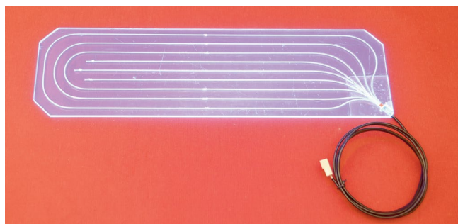
Рис. 8. Фото продольного тонкого счетчика вето-детектора без светоизолирующей бумажной и светоотражающей (Тайвек) оберток.
