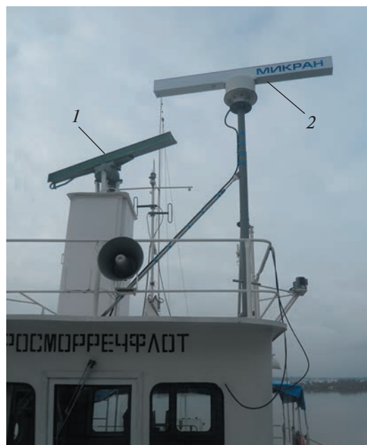
Рис. 6. Внешний вид антенн РЛС на речном судне. 1 – антенна судовой РЛС Р-722-2; 2 – антенна судовой РЛС “Река”.
