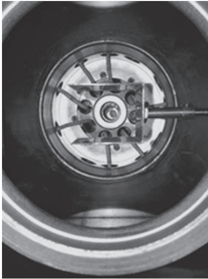
Рис. 8. Фотография области влета пучка в ионизатор. Видна заслонка для перекрывания пучка, укрепленная на вводе вращения.
