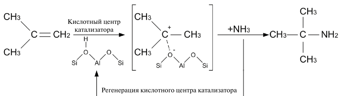
Рис. 9. Реакция изобутилена с аммиаком на твердокислотных катализаторах.
