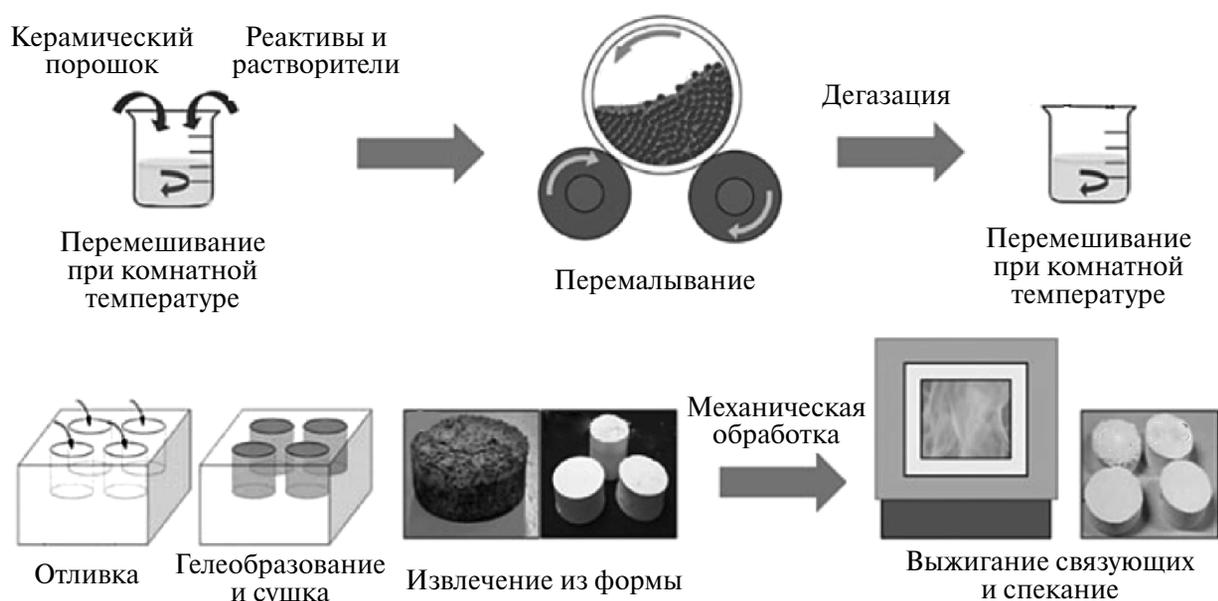
Рис. 9. Схематическое изображение метода пропитки гелем пористых заготовок.
