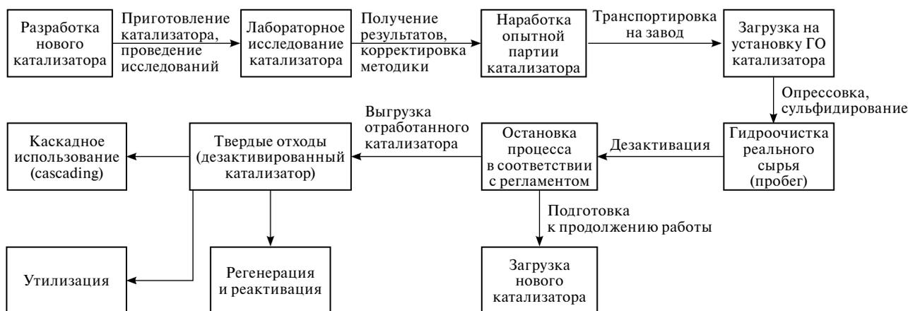
Рис. 1. Упрощенная схема «жизненного цикла» катализатора гидроочистки.
