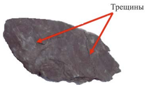
Рис. 4. Развитие микротрещин в аргиллите пласта Сишанью.
