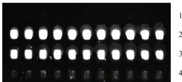
**Рис. 9.** Картина флуоресценции ячеек чипа на канале Су3 с иммобилизованными ДНК-зондами при микрокапельном нанесении растворов, содержащих различные концентрации глицерина. Выдержка 100 мс. Буфер карбонатный, рН 9.0, 10% формамида. 1 – пустые ячейки; 2 – 5% глицерина; 3 – 10% глицерина; 4 – 20% глицерина.
