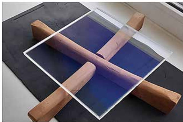
Рис. 2. Фотография нелинейного оптического элемента из монокристаллического кристалла KDP размером 180 \times 180 \times 10 мм.
