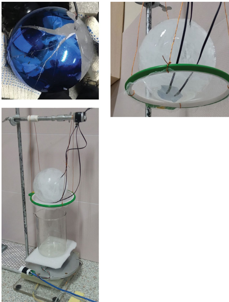
Рис. 2. Этапы эксперимента: замораживание воды в пластиковой форме с термодатчиком в центре в морозильной камере, отделение пластиковой формы, взвешивание ледяного шара, его фиксация над стаканом для сбора талой воды, непрерывное измерение массы талой воды и температуры как внутри, так и снаружи ледяного шара.
