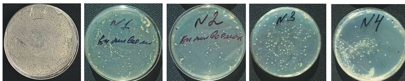
Рис. 5. Изображения образцов с бактериями Staphylococcus aureus после антибактериального теста. Слева показан контрольный образец — матрица без покрытия. 1 — SDND, 2 — SDND—лизозим—мирамистин, 3 — DND, 4 — DND—лизозим—мирамистин.
