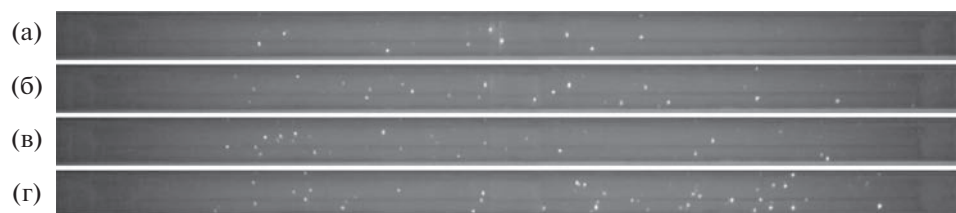
Рис. 10. Кадры видеогаммы зажигания и горения частиц смеси У 70% + Б 30% размерами 100–200 мкм в условиях движения в потоке разогретого воздуха при T_a = 700^\circ\text{C} ( \Delta t = 0.01 с): t_d = 0.052 с (а); t = t_d + \Delta t (б); t = t_d + 2\Delta t (в); t = t_d + 3\Delta t (г).
