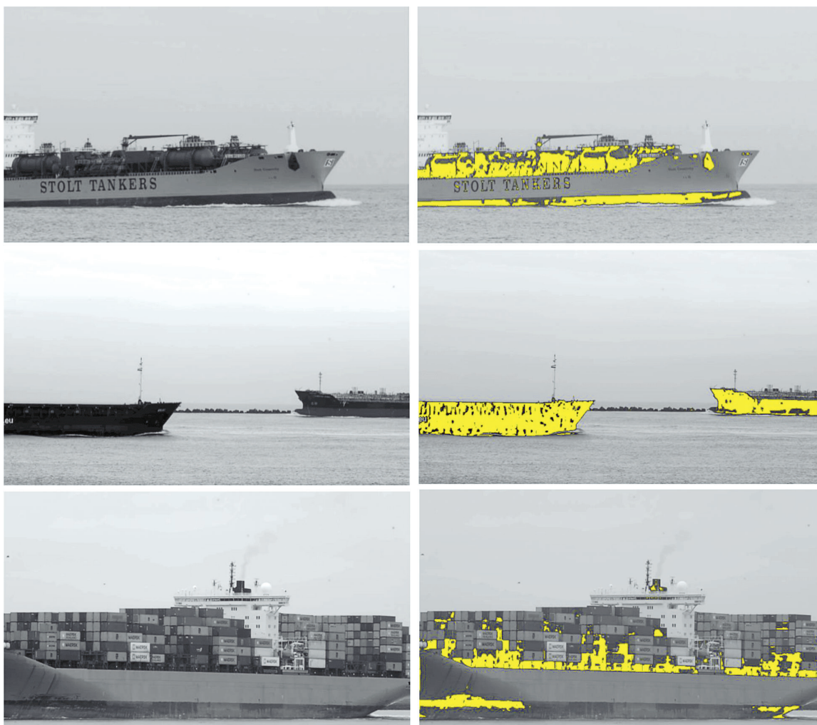
Рис. 7. Визуализация разности соседних кадров на примере судов разного размера, с разной скоростью движения и на различных расстояниях от причала
