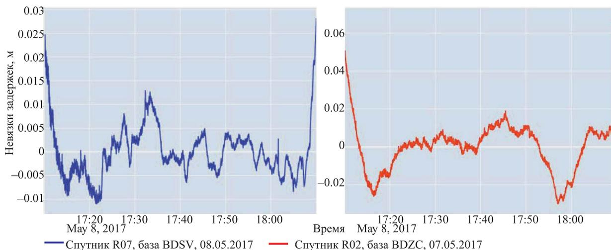
**Рис. 10.** Погрешность сличения опорных и фактических измерений разностей дальностей между станциями РСДБ и НКА.
