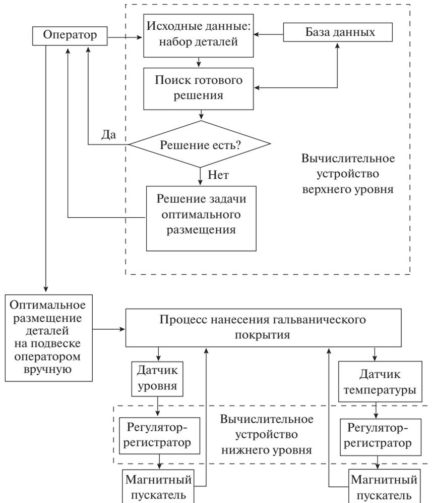
Рис. 1. Функциональная схема системы управления
