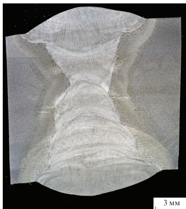
Рис. 1. Общий вид сечения сварного шва.
