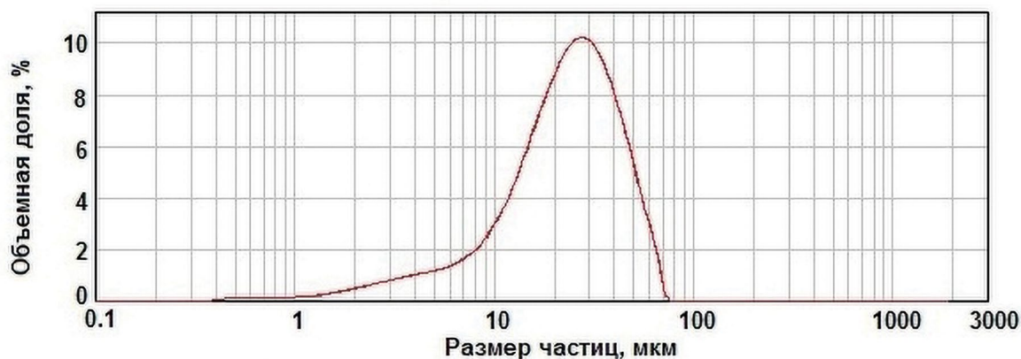
Рис. 7. Дифференциальное распределение по размерам композиционного порошка Ti с диборидом гафния.
