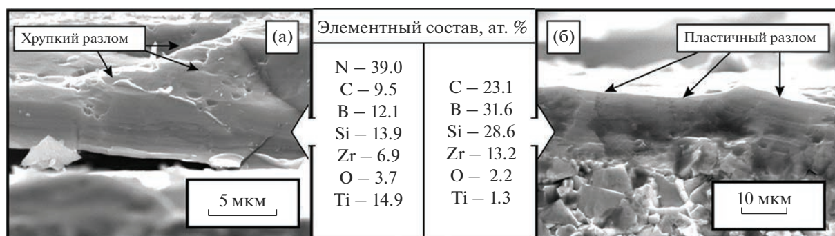
Рис. 2. Изображения поперечных изломов покрытий Zr–B–Si–C–Ti–N (а) и Zr–B–Si–C–Ti (б).
