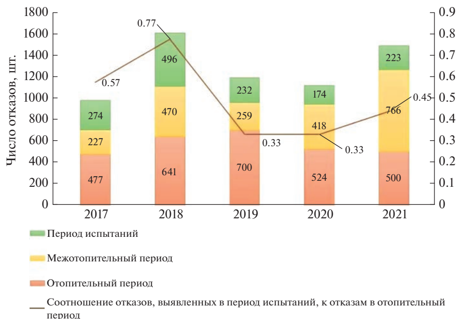
Рис. 3. Корреляция между отказами в тепловых сетях, выявленными в период испытаний и в отопительный период в г. Новокузнецк за 2017–2021 гг.
