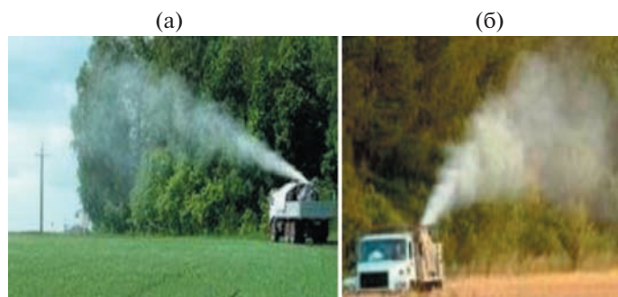
Рис. 5. Общий вид аэрозольной струи, создаваемой газотермическим генератором ГАРД, установленным в кузове автомобиля: (а) — аэрозольная струя направлена по движению автомобиля, (б) — аэрозольная струя направлена против движения автомобиля.
