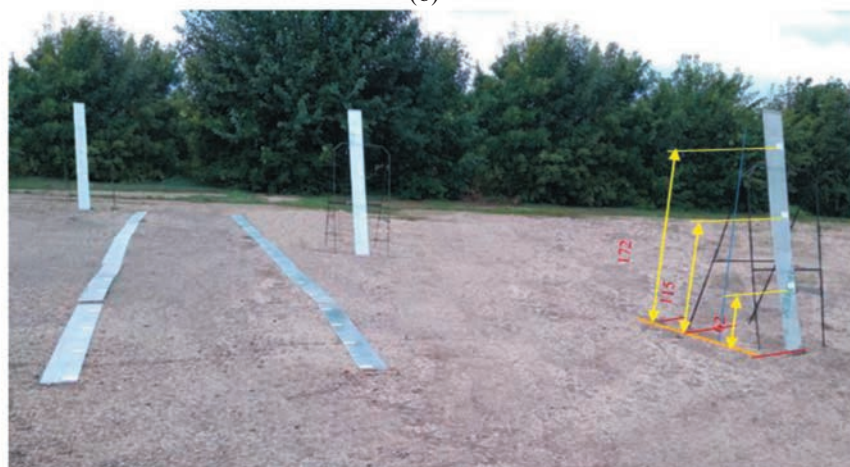
Рис. 9. Расположение планшетов с предметными карточками на площадке для получения информационных данных по дисперсности капель, создаваемых режимом технического средства: (а) — измерение расстояний рулеткой от сопла до начала расположения планшетов и расстановка карточек, (б) — расположение планшетов на площадке с предметными карточками.
