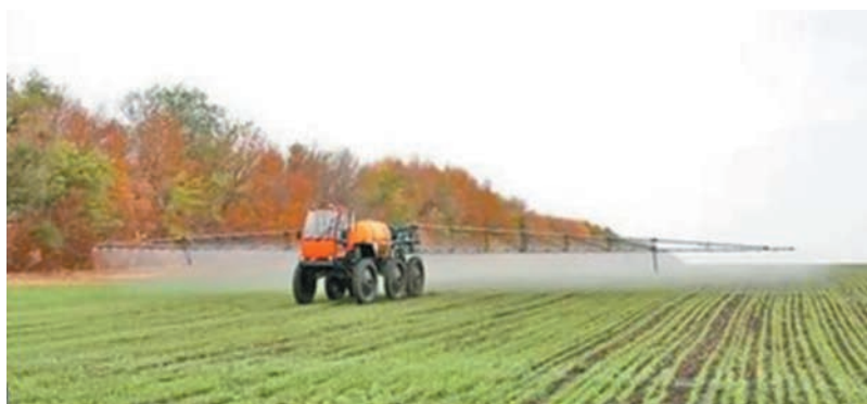
Рис. 2. Самоходный штанговый опрыскиватель в технологическом процессе краевой обработки полей от сорняков и вредителей.
